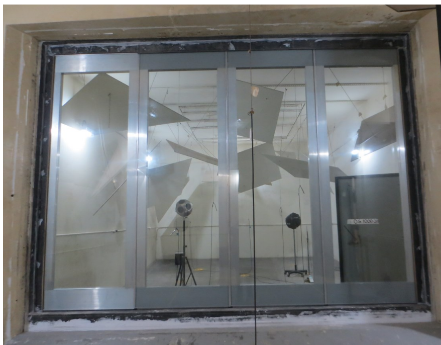
Figura 16 – Divisória vista da câmara de emissão.
